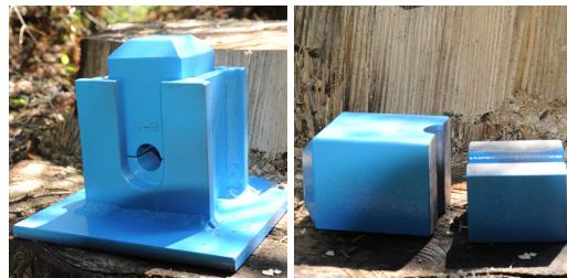
**Empfehlung:** verwenden Sie bei den Presshülsen immer eine Nenngröße grösser als der Seil-Ø des Forstseils (z.B. Seil-Ø 12 mm = Einsatz 12-13 mit Hülsen NG 13 mm)
