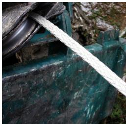
hochfestes, verdichtetes und gestrecktes Hochmodul-Polyethylen-Faserseil mit spezieller PU-Beschichtung
