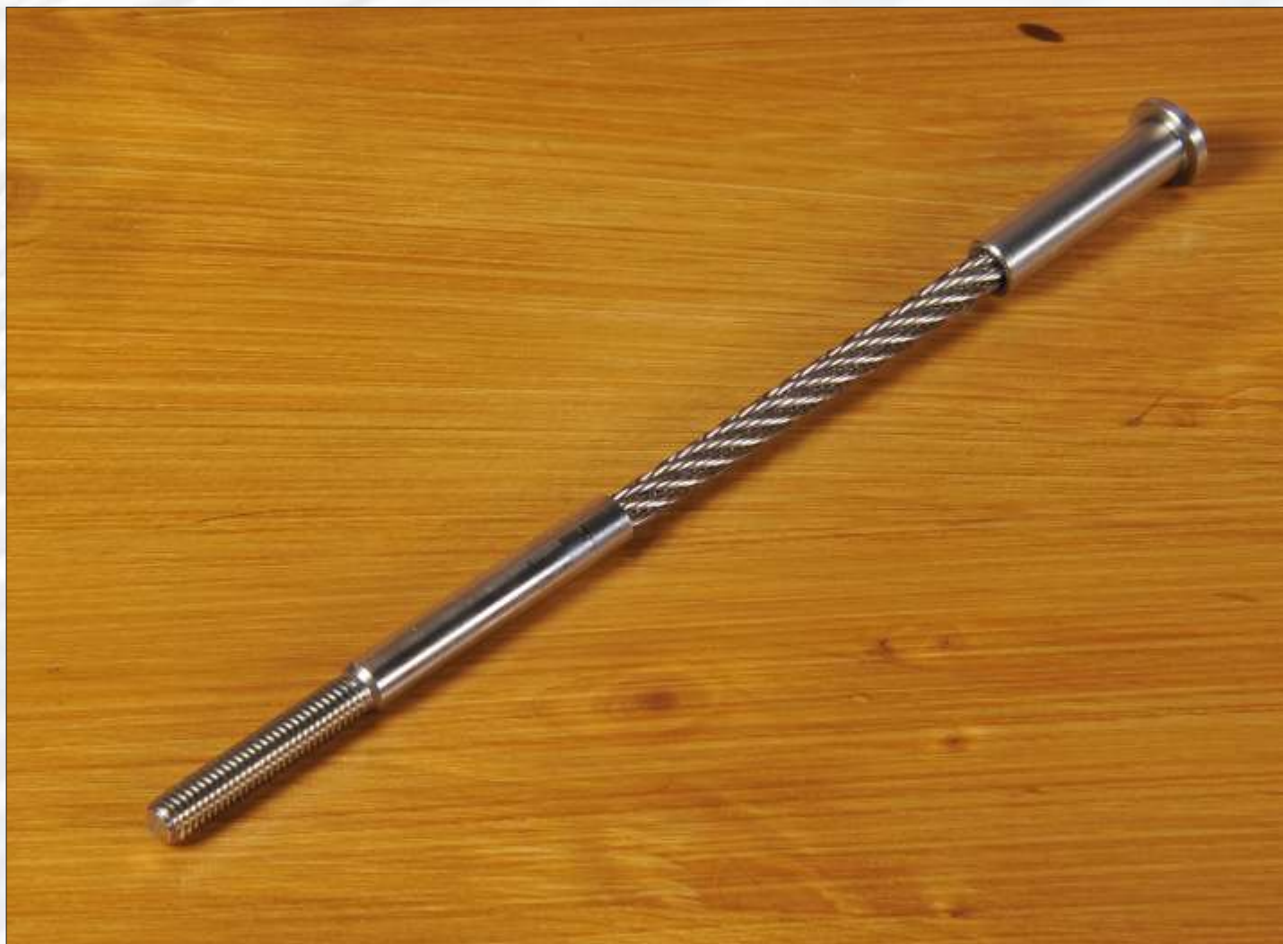
E1 INOX-Drahtseil Konfektion E1 (APG-EHL) einseitig mit Anpress-Aussengewinde, anderseitig mit Endhülse mit Linsen Kopf
