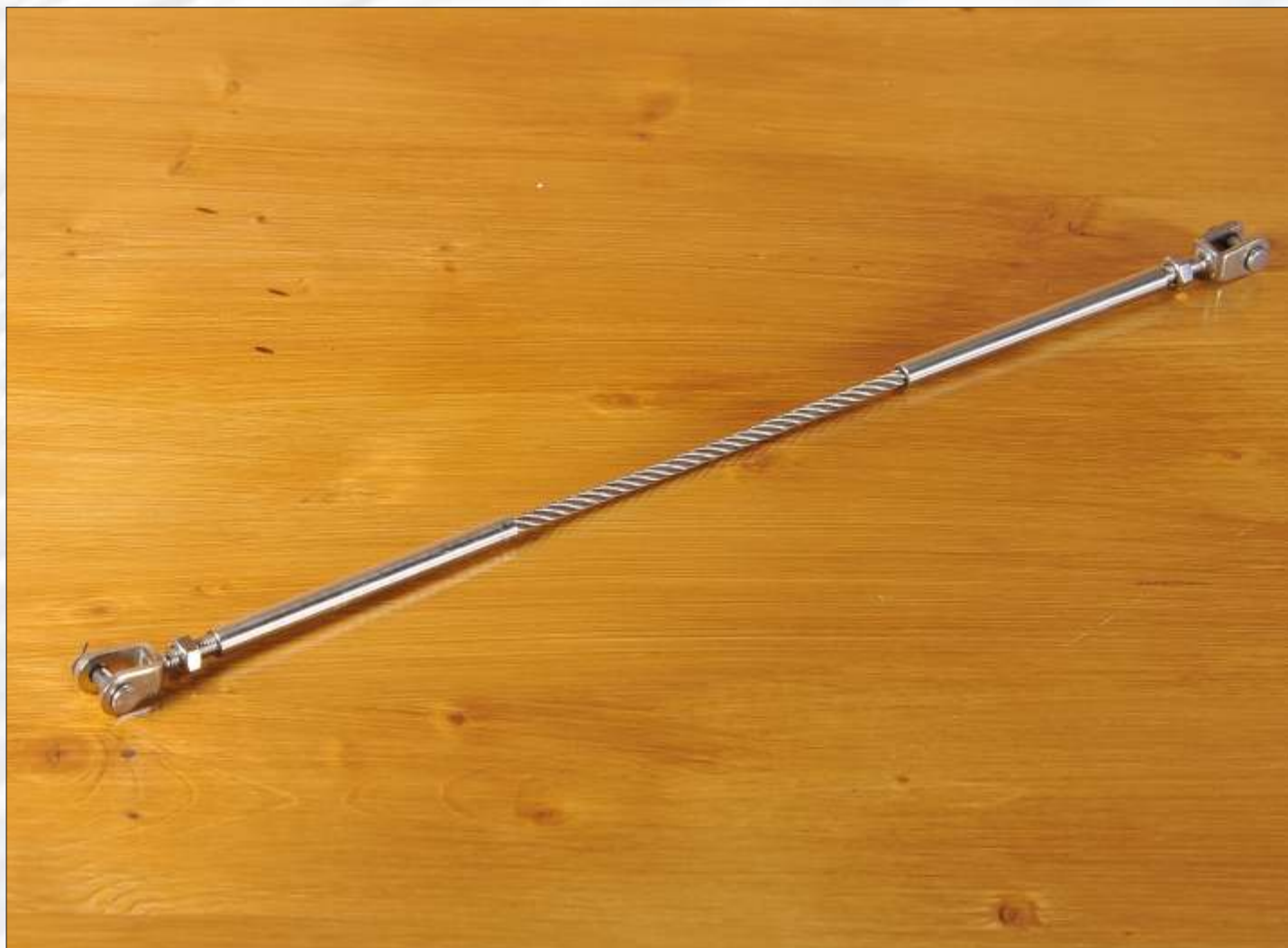
G1 INOX-Drahtseil Konfektion G1 (GGIG-GGIG) beidseitig mit Innengewinde mit Gewindegabel auf Seil verpresst
