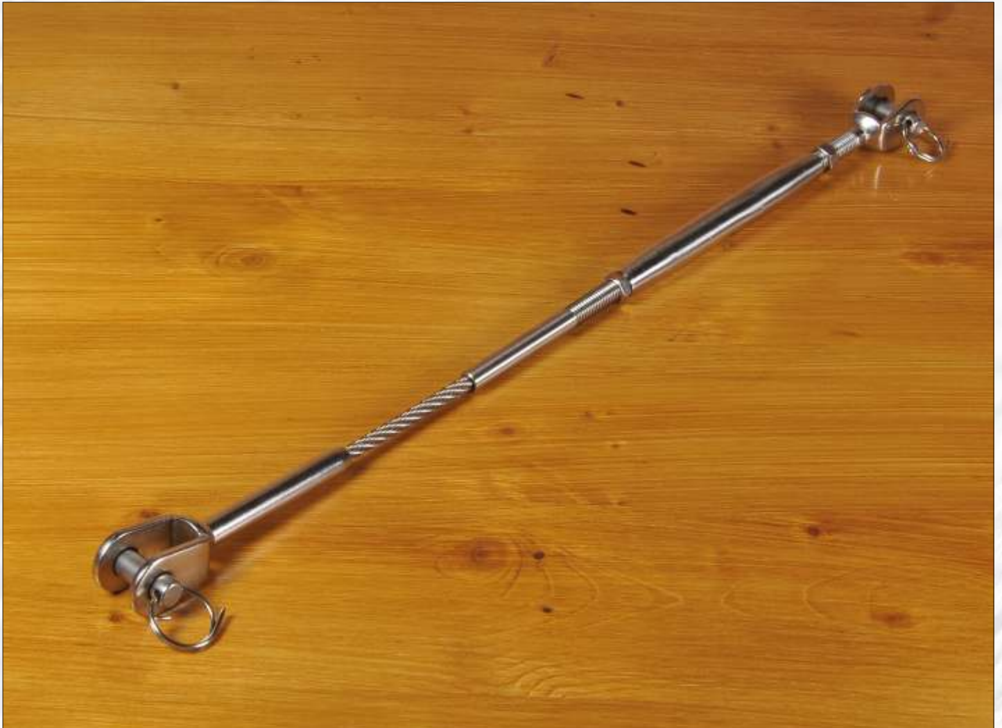
G3 INOX-Drahtseil Konfektion G3 (AG-GGSA) einseitig mit Anpressgabel, anderseitig mit Gabelspanner auf Seil verpresst
